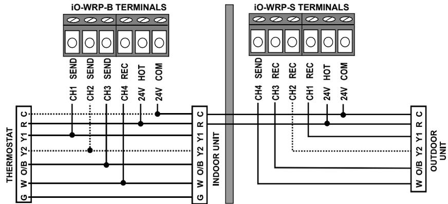
**HEAT PUMP UPGRADE WITH NO WIRES TO OUTDOOR UNIT**
